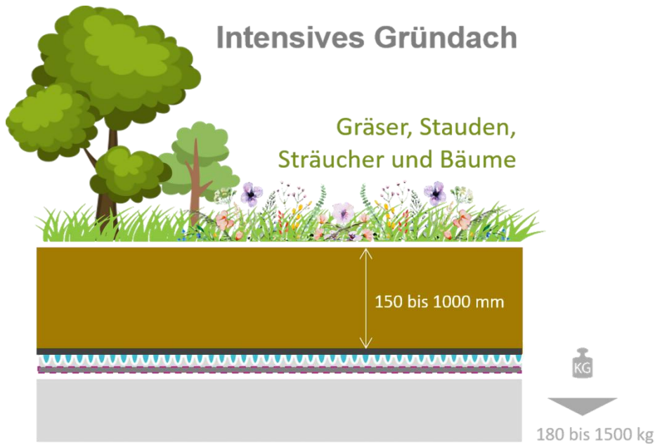
Abbildung 14: Schema intensives Gründach Quelle: TH Köln (2025)
