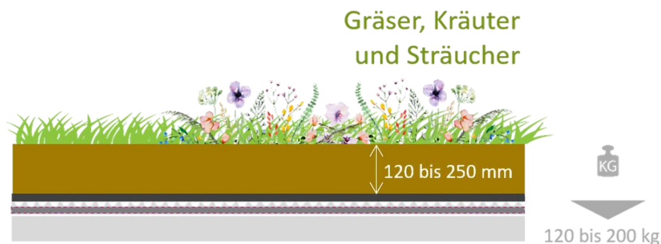
Abbildung 13: Schema semi-intensives Gründach Quelle: TH Köln (2025)
